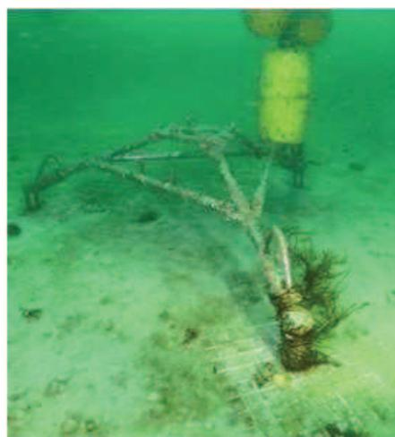
**Figure 37. Essai de déploiement de cage tripode inox récupérable**
