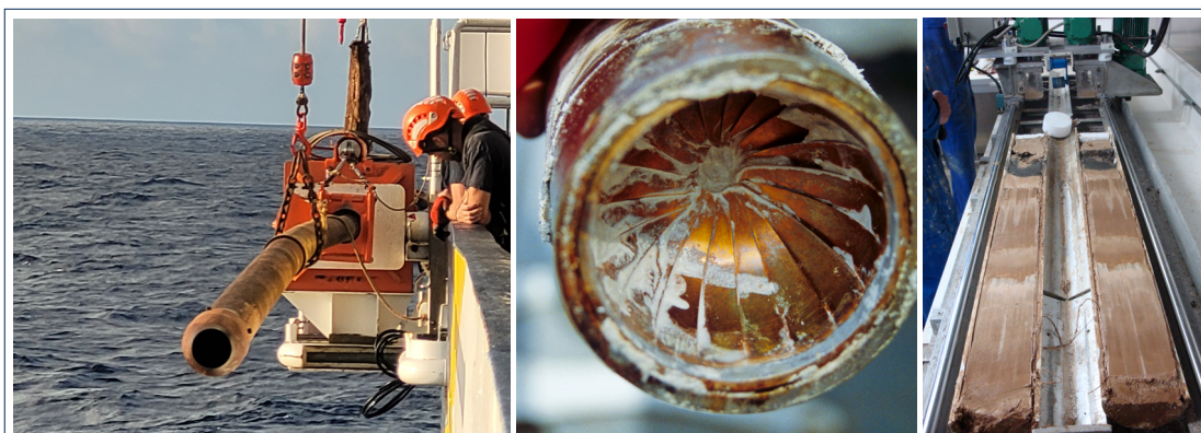
Carottier gravitaire (à gauche) - Diaphragme ou «peau d'orange» retenant le sédiment dans le carottier (au centre) - Carotte de sédiments (à droite)
