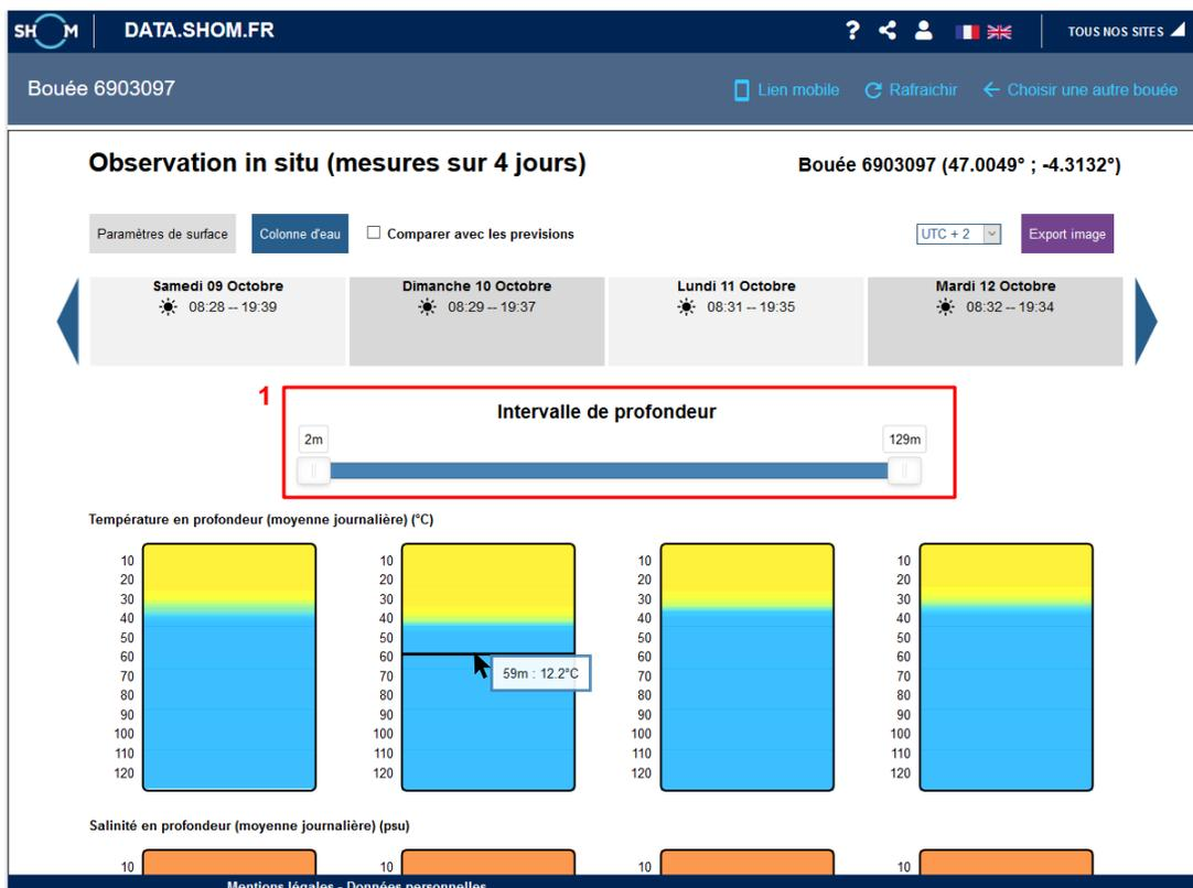
Les paramètres de température et/ou de salinité mesurés selon des profils verticaux sont représentés sous la forme de diagrammes quotidiens permettant de visualiser l'évolution du paramètre sur la colonne d'eau.
